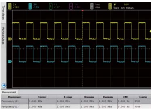
示波器测量 1KHz · 2.5Vpp 的方波
