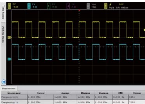
示波器量測 1KHz · 2.5Vpp 的方波
