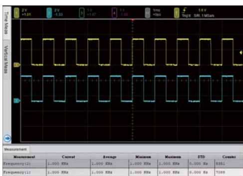
示波器测量 1KHz · 2.5Vpp 的方波
