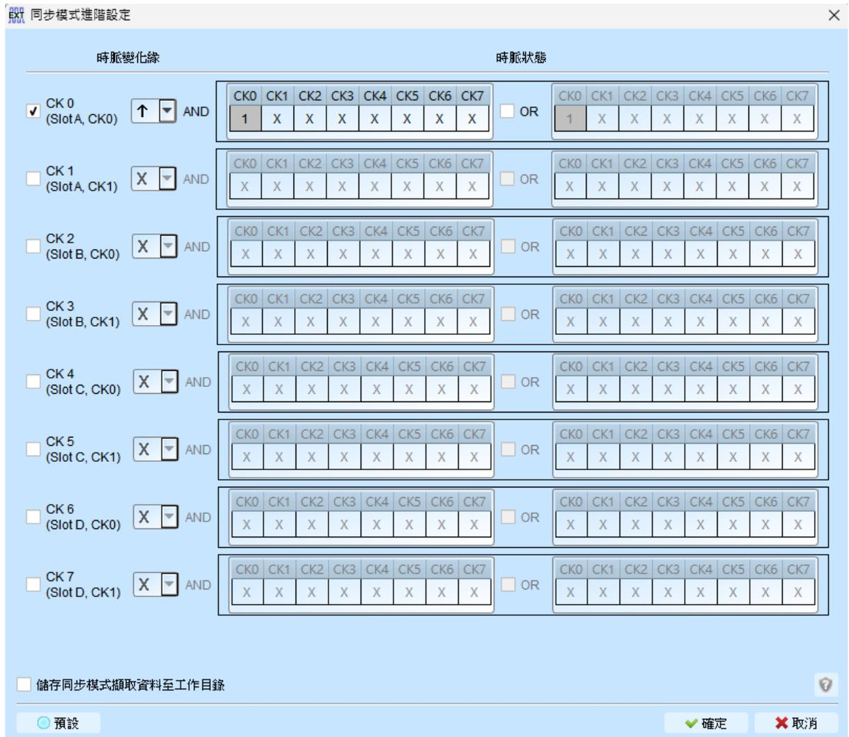
而進接設定可以同時使用多組 Edge 條件進行取樣，每組 Edge 條件都可以搭配兩組限定條件(Qualifier)，任一條件成立即會進行取樣。例如下圖的設定條件:
