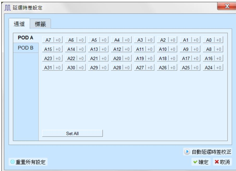
自動延遲時差校正需先設定所使用的時脈通道及採樣邊緣，之後按下開始校正按鈕就會以設定條件進行採樣並提供合適的延遲校正數值。
