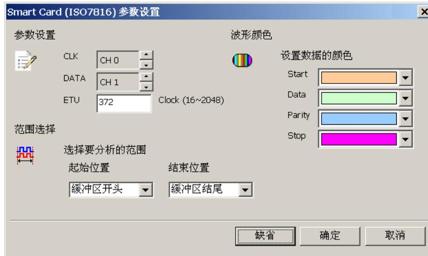
**参数设置:** 设置待测物上各个信号端接在逻辑分析仪的通道编号。
