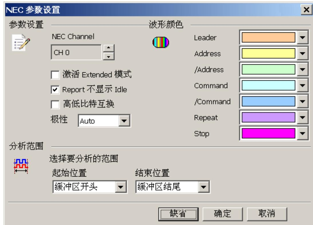
**参数设置:** 设置 NEC 的信号接在 LA 的通道编号。
