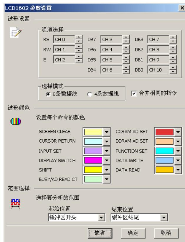
**通道选择:** 设置待测物上各个信号端接在逻辑分析仪的通道编号。
