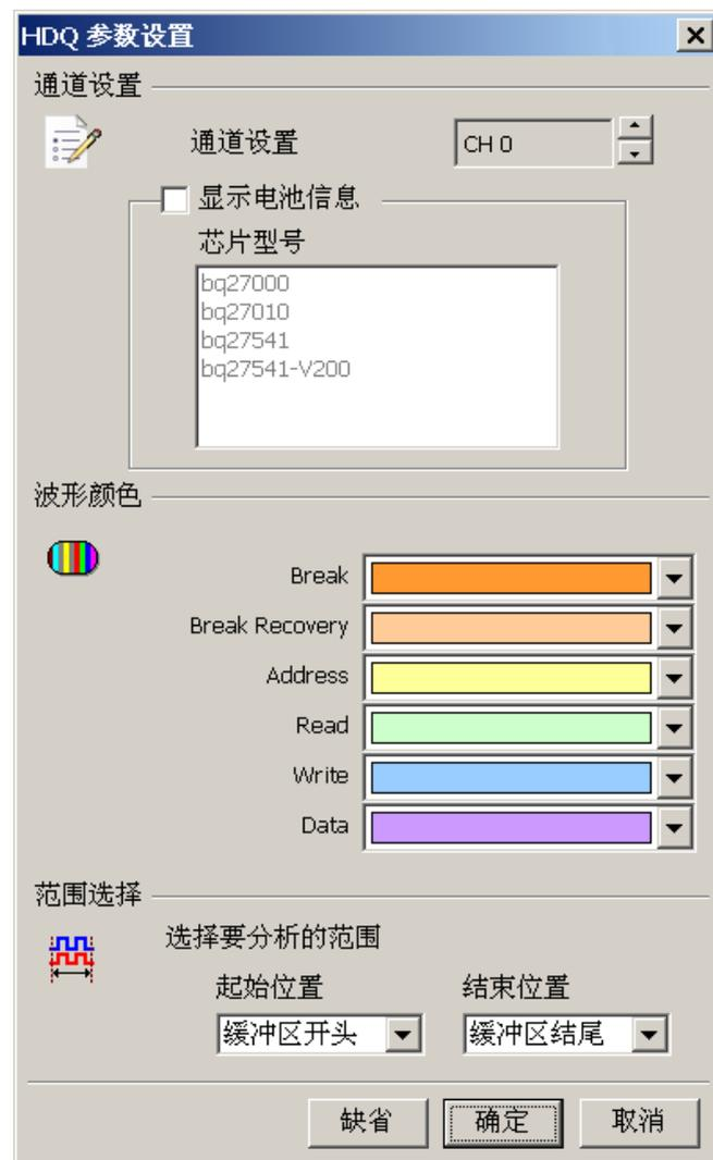
**通道设置:**设置待测物上的信号端接在逻辑分析仪的通道编号。
