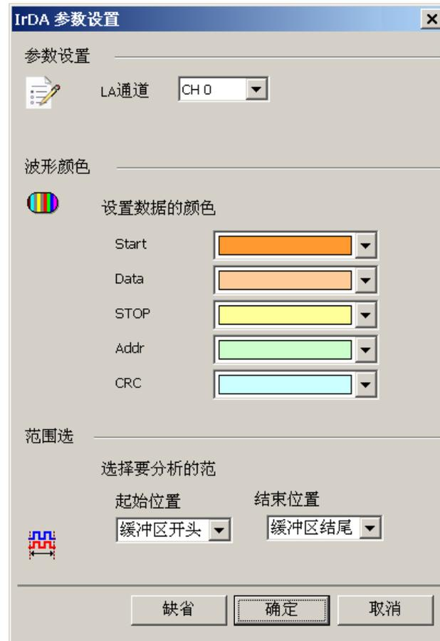
**通道设置:** 设置待测物上，各个讯号端接在逻辑分析仪的通道编号。
