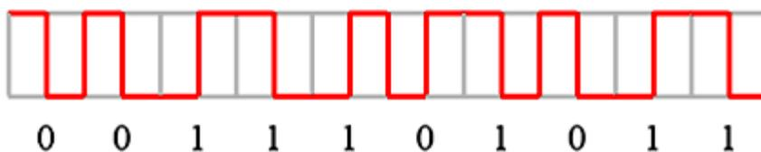
双相符号编码，是许多数字录音采用的编码技巧。把数据位拆成两个部分，若数据为 1 时，则拆成 01 或 10。若数据为 0 时，则为 00 或 11。每个数据位结束时必须反向，这样接收端就能以接收到的信号自己做信号同步的工作。例如：一个数据串流包含的位依序为"0010110010"，通过编码则为"11 00 10 10 10 11 01 00 10 10"。
