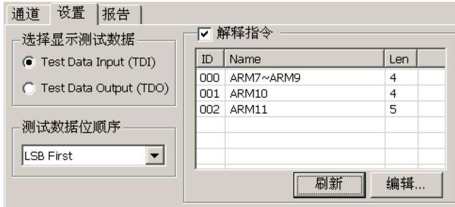
**选择显示测试数据(Test data):** 使用者可选择当 TAP state 的状态为 Shift-IR、Shift-DR。将会以 16 进制显示 TDI 或 TDO 的数据。
