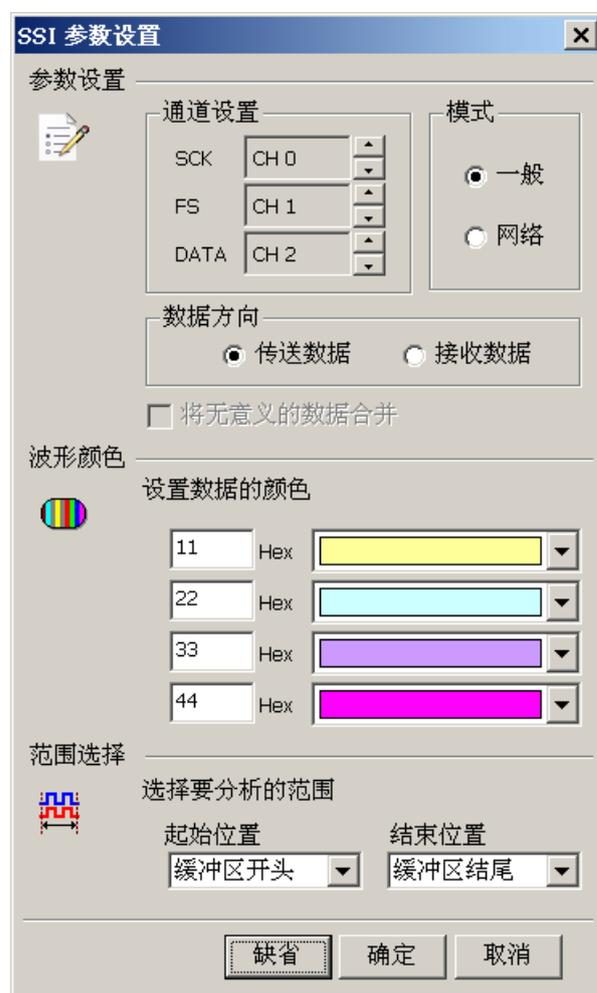
**通道设置:** 设置待测物上各个信号端接在逻辑分析仪的通道编号。
