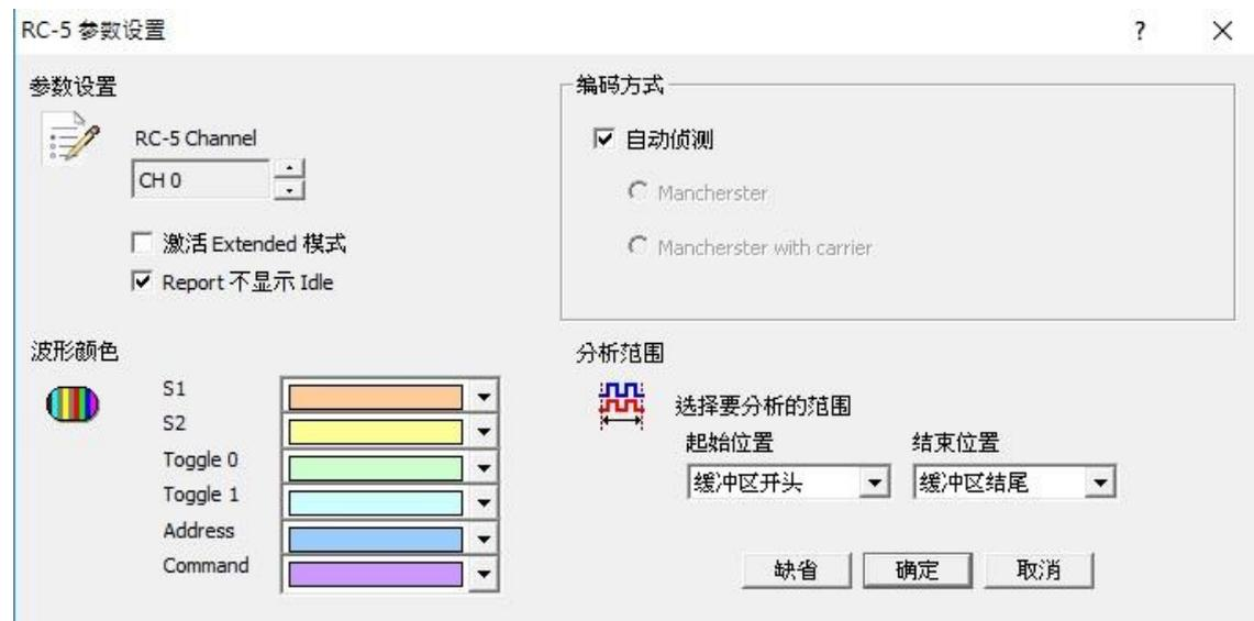
**参数设置:** 设置待测物上的信号端接在逻辑分析仪的通道编号。
