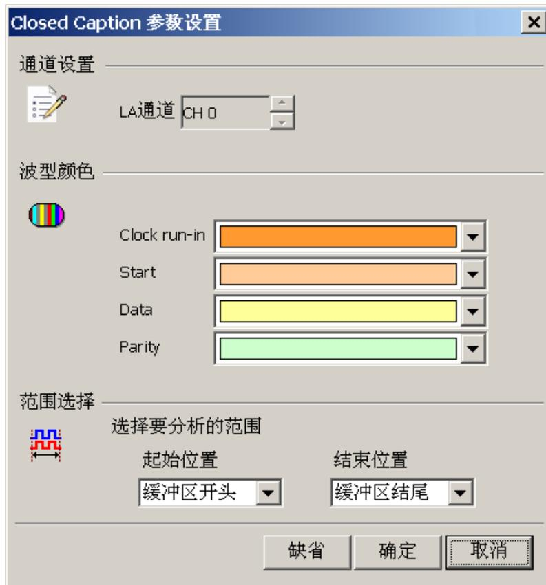
**通道设置:** 设置待测物上的信号端接在逻辑分析仪的通道编号。
