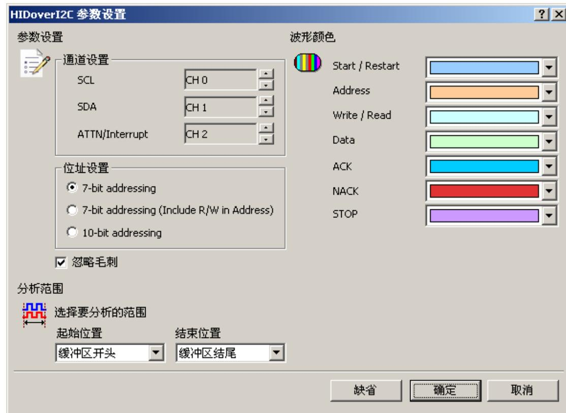
**通道设置:** 设定待测物上，各个信号端，接在逻辑分析仪的通道编号
