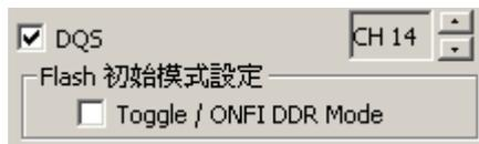
当欲触发 NAND Flash DDR 模式下之 Command / Address / Data 时, 请务必勾选 DQS, 并勾选 Flash 初始模式设定 Toggle / ONFI DDR Mode; 若是 SDR 模式下, 则无须理会 Flash 初始模式设定。
