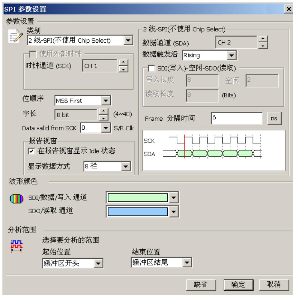
在不使用 Slave select，且 Frame 之分隔时间为 0 时，可成为另一种连续数据的分析，如下图所示。信号只有 CLK, DATA。而 Frame 分隔时间为 0，数据触发沿在 Falling。
