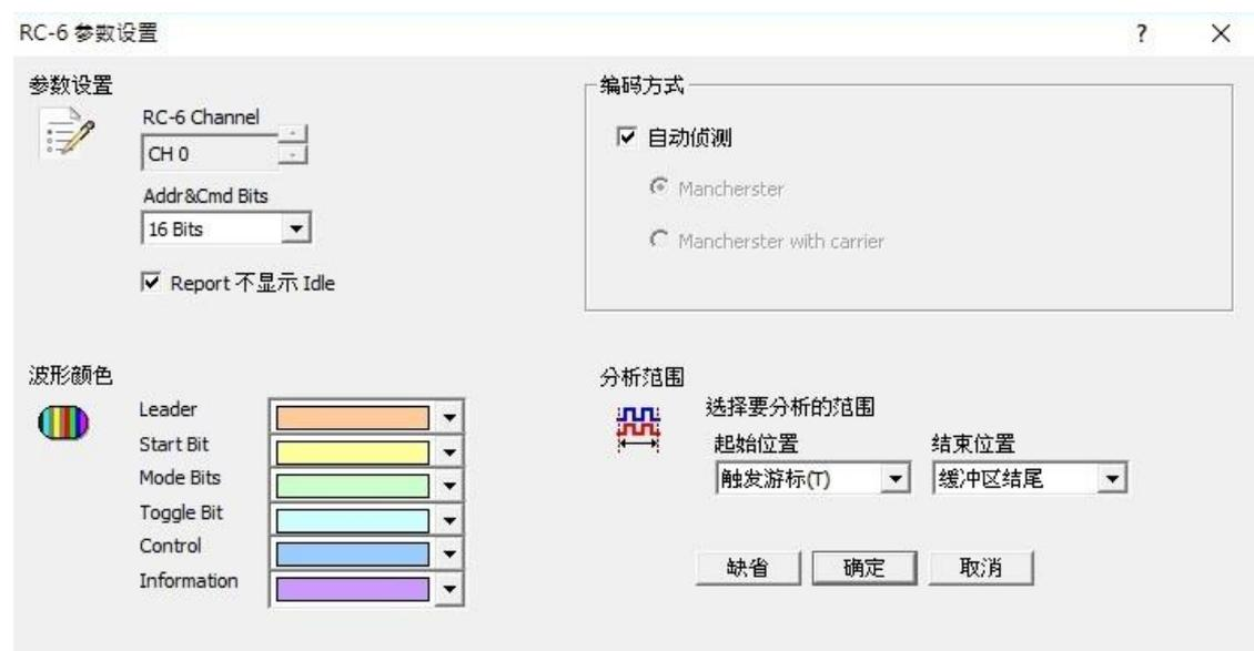
**参数设置:** 设置待测物上的信号端接在逻辑分析仪的通道编号。
