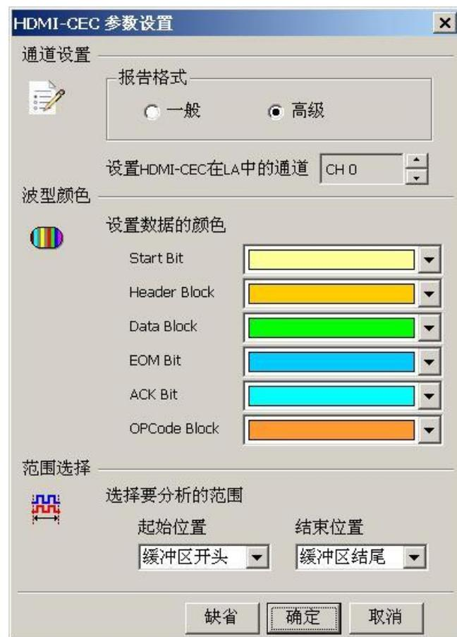
**通道设置:** 设置待测物上, HDMI-CEC 接在逻辑分析仪的通道编号。
