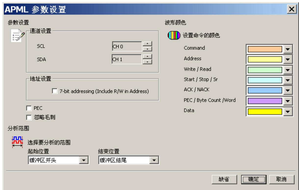
**通道设置:** 设置待测物上，各个信号端，接在逻辑分析仪的通道编号。
