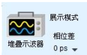
图-二中将 BNC-MCX cable 连接 MSO Trig-In 与示波器的触发输出接口 (Trig-Out)。完成上述动作之后，按下「堆叠示波器」钮。如下图：
