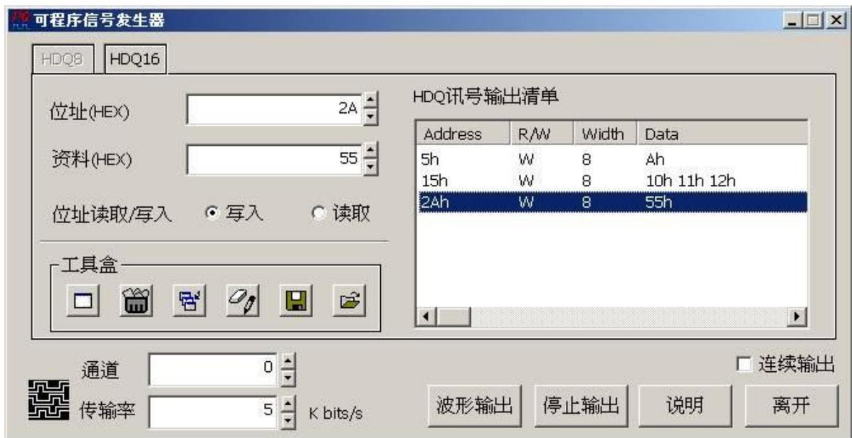
HDQ 信号发生器的使用方法主要是根据您的信号需求，输出列表里的每一列就代表一个封包。举例来说：假设要产生一个地址为 41h、地址写入、8 位数据宽度然后数据为 20h 的 HDQ 封包。操作步骤如下：1.按下 HDQ8 按钮(选择 8 位数据宽度，此为程序默认项目)2.分别在地址与数据填入 41h 和 20h，勾选写入 3.按下工具箱中的『新增项目到信号列表』请参考下图。
