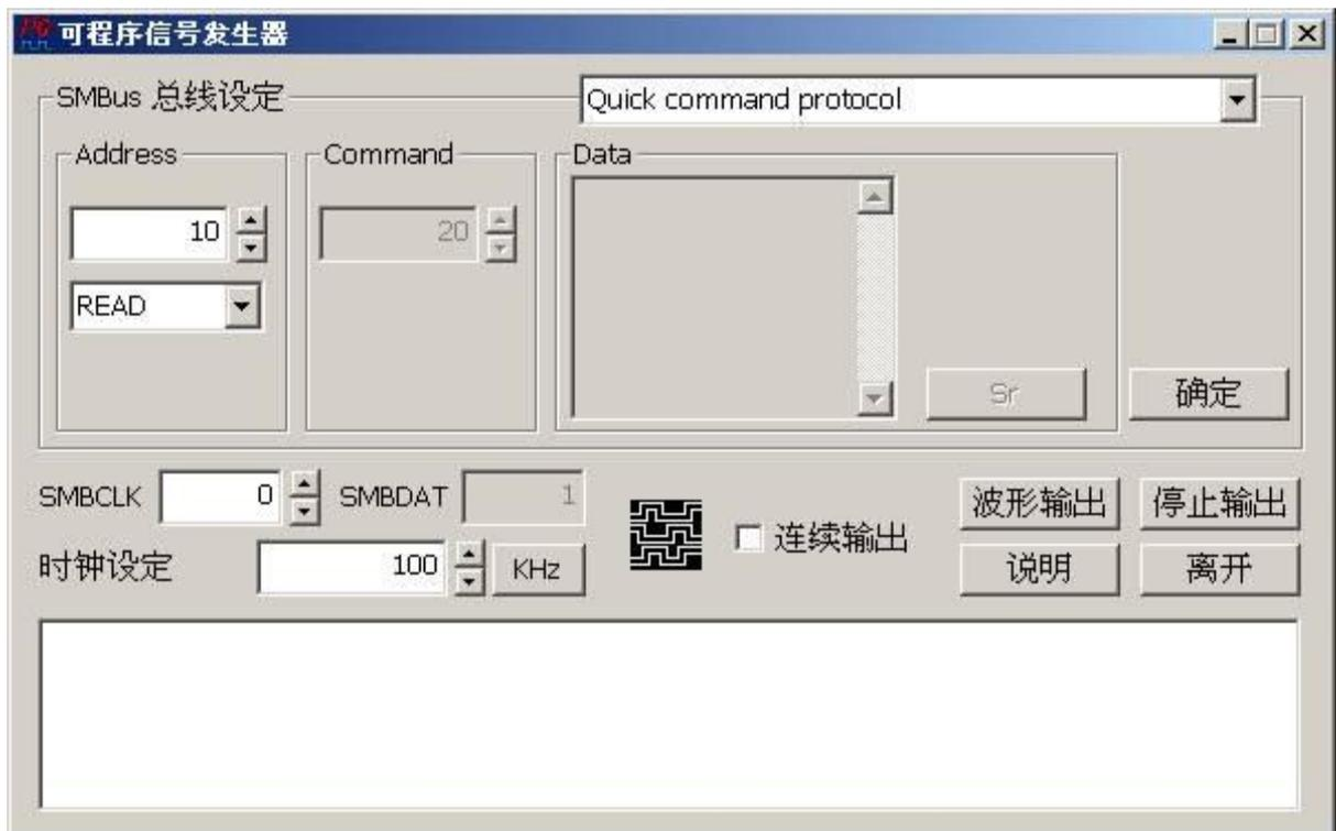
SMBus 信号发生器的使用方法主要是根据您的信号需求，来编辑 SMBus 输出封包让数据产生器依照您的信号列表来输出该信号，输出列表里的每一列就代表一个封包。
