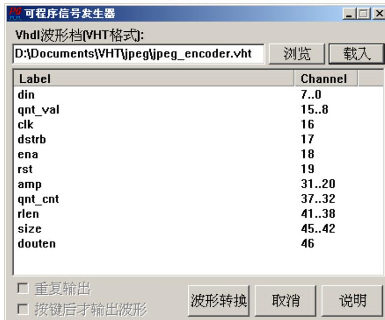
选择要转换的 VHT 档案，然后根据您的需求，选择是否要重复输出或是要按键后才输出波形，当然也可以同时勾选或不勾选。再按下加载键，再按下波形转换键。转换程序会将 VHT 档案中的信号依输入信号组、输入单一信号、输出信号组以及输出单一信号的顺序作转换。
