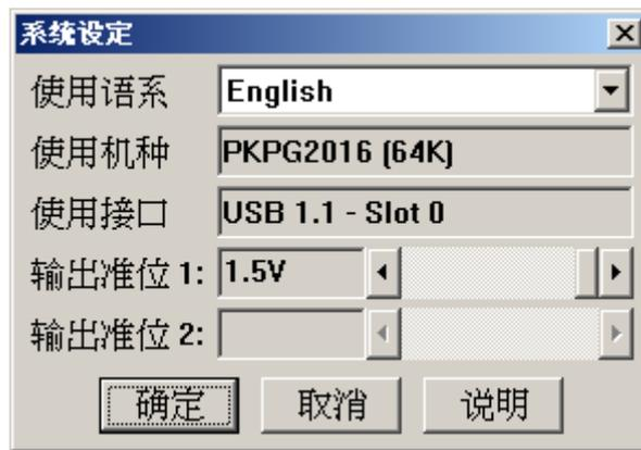
系统内容设定主要是设定程序的使用语系，每一种语系可以随时自由的切换，可以根据个人需求来做调整。另外还有两个讯息字段，一个是使用机种，另一个是使用界面。
