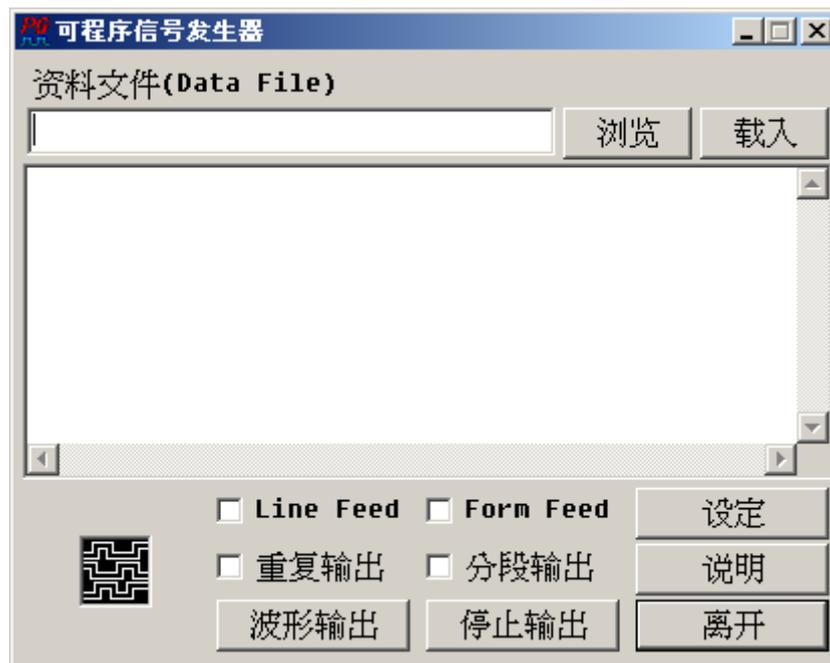
并行信号发生器的用法有二。一是，输入一个打印机可以识别的档案，这个档案可以是纯文本文件或是含有打印机句柄的档案。二是，直接在文字编辑区里输入纯文本数据。如果输入档案的是一个纯文本档案，可以按下载入钮，将档案加载编辑区中做修改。数据的尾端也可以加入跳行(LINE FEED)或跳页(FORM FEED)的指令。
