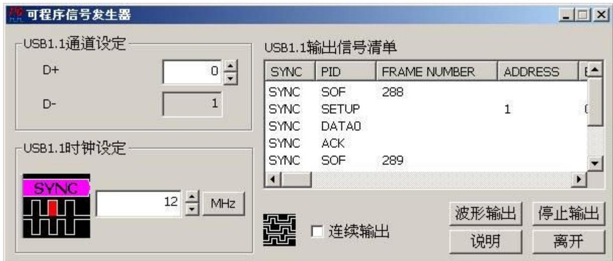
USB1.1 信号发生器的使用方法主要是根据您的信号需求，来编辑 USB1.1 输出封包让数据产生器依照您的信号列表来输出该信号，输出列表里的每一列就代表一个封包。
