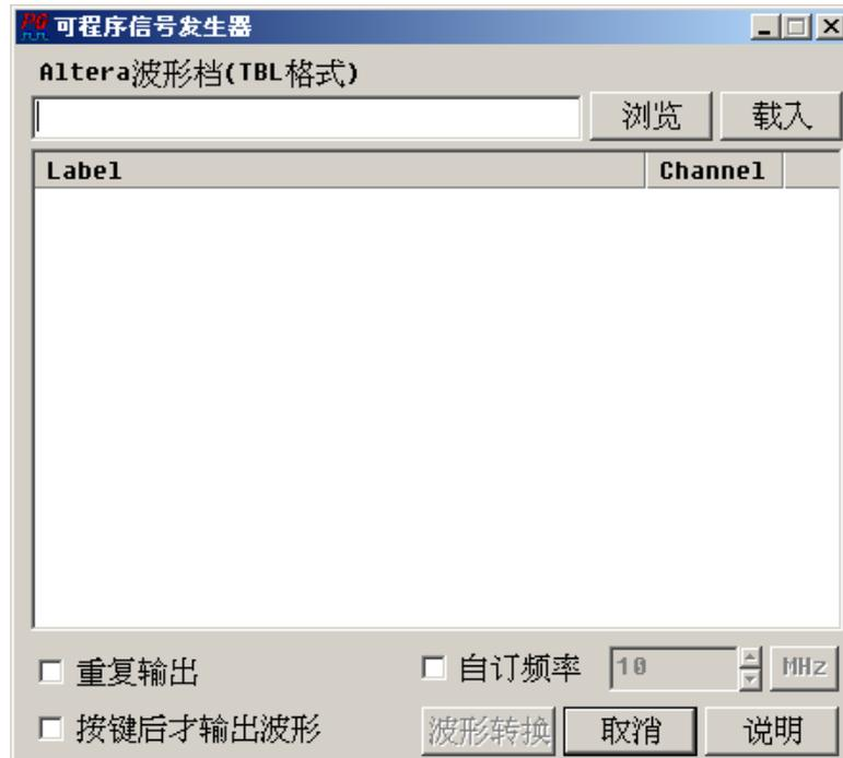
首先要先输入一个 Max Plus II 的 Table 档，然后按下加载钮。此时在表列区中就会出现待转换的信号名称和转成 Acute PG 后的信道号码。由于 Acute PG 是一个输出信号的仪器，所以转换程序只会将 Table 档案中的输入脚的信号取出并加以转换。这时『单位设定』会出现经过换算的时间单位，由于 Acute PG 的最小时间单位为 10ns，所以如果 Table 文件所用的时间单位小于 10ns，转换程序就只会设定成 10ns。但是这个时间单位亦可以自行修改，以配合实际的需求。在转换的过程中也可以加入『重复输出』或是『按键后才输出波形』的选项。『重复输出』就是让 Table 档的波形可以不断的重复输出。『按键后才输出波形』的选项是代表当您执行输出波形前会暂时停止，然后再按下启动热键才会真正输出波形。一旦两个选项同时选择时，可以达到重复测试待测电路以外，而且每测试完一次都可[停下来](#)，等待下次按键再行测试。
