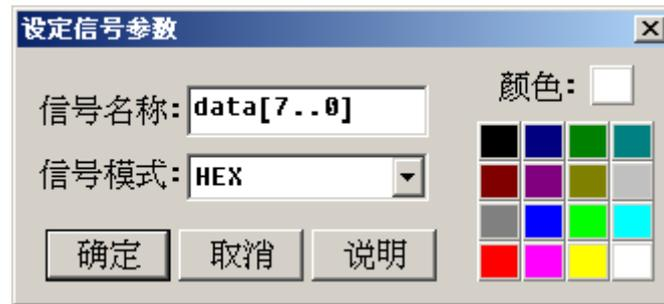
设定信号参数的启动有两种方法，一是将鼠标移到需要改变信号参数的信号名称上，并按下鼠标右键，再从信号选单中选择『内容』的选项。另一个方法是将鼠标移到需改变信号参数的信号名称上，并按鼠标左键两下(Double Click)。两种方法都会在画面上出现设定信号参数的对话框。所以设定信号参数的用途，是在已经存在的信号需要改变设定时使用。信号参数可以设定单一信号或是信号组，设定的部份有三项，一是信号名称，二是信号模式，三是信号颜色。但是如果设定的是单一信号时，信号模式无法设定。而信号模式主要是设定信号组的表示方式，有 HEX、DEC、OCT、BIN 和 ASC 等选项。
