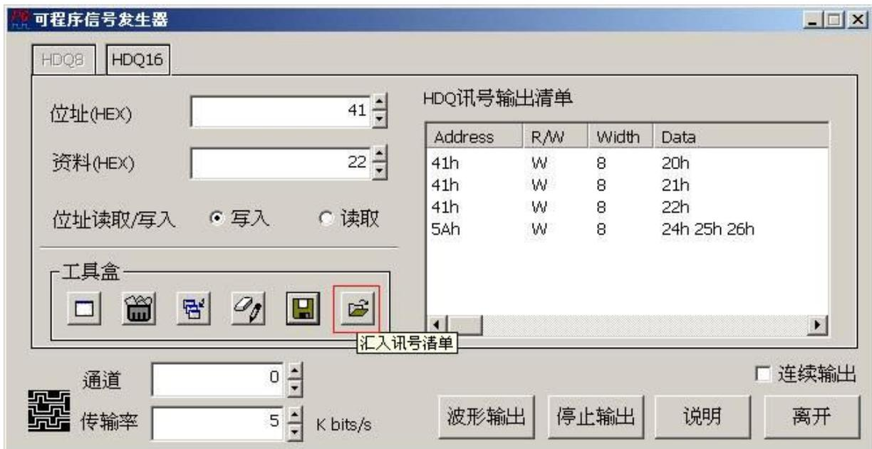
『信道』可以让您选择数据产生器的输出信道，0 表示选择信道 0 来输出 **HDQ** 信号，1 表示选择信道 1 来输出，依此类推。
