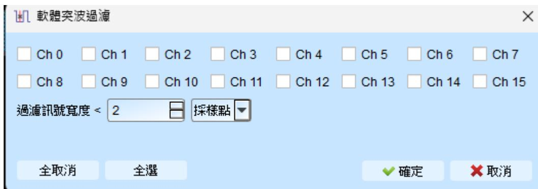
本過濾功能可設定過濾小於 1ps 到 1ms 時間寬度的訊號，啟用軟體過濾僅會影響顯示及匯流排解碼功能，並不會影響觸發功能以及可擷取的記錄長度，關閉此過濾功能後波形將會還原回過濾前的波形。
