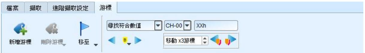
4. 尋找特定波形寬度，根據指定的通道搜尋符合條件的脈波寬度波形
