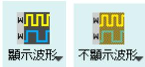
若選擇顯示波形(Show Waveforms)，則會擷取波形資料，此功能需在擷取開始前設定開啟或關閉。選擇顯示波形會佔用較多的裝置記憶體。
