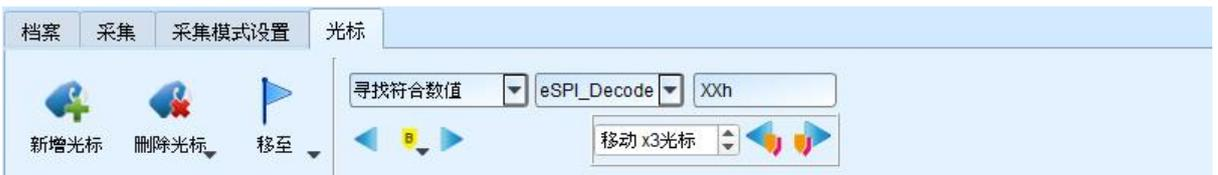
4. 寻找特定波形宽度，根据指定的通道搜寻符合条件的脉冲宽度波形
