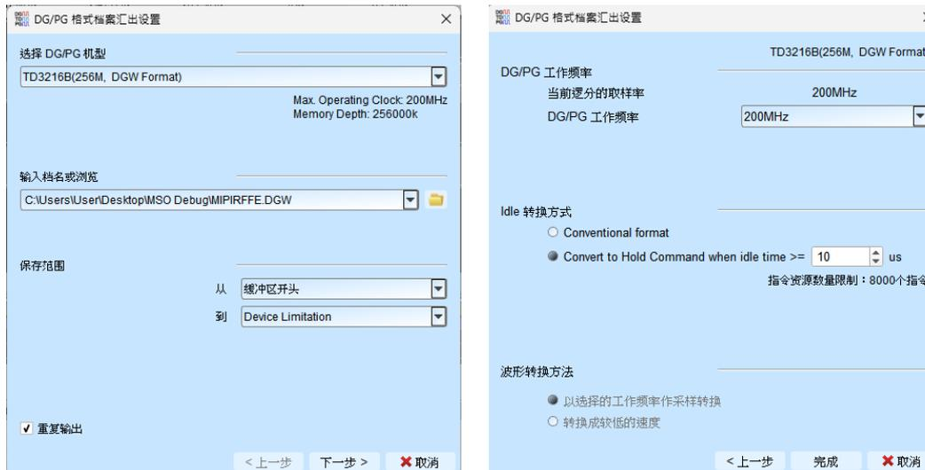
1. 选择 DG/TD/PG 机型：选择 DG/TD/PG 机型后软件将会自动套用该机种的硬件规格限制，包含工作频率以及最大记忆长度。
