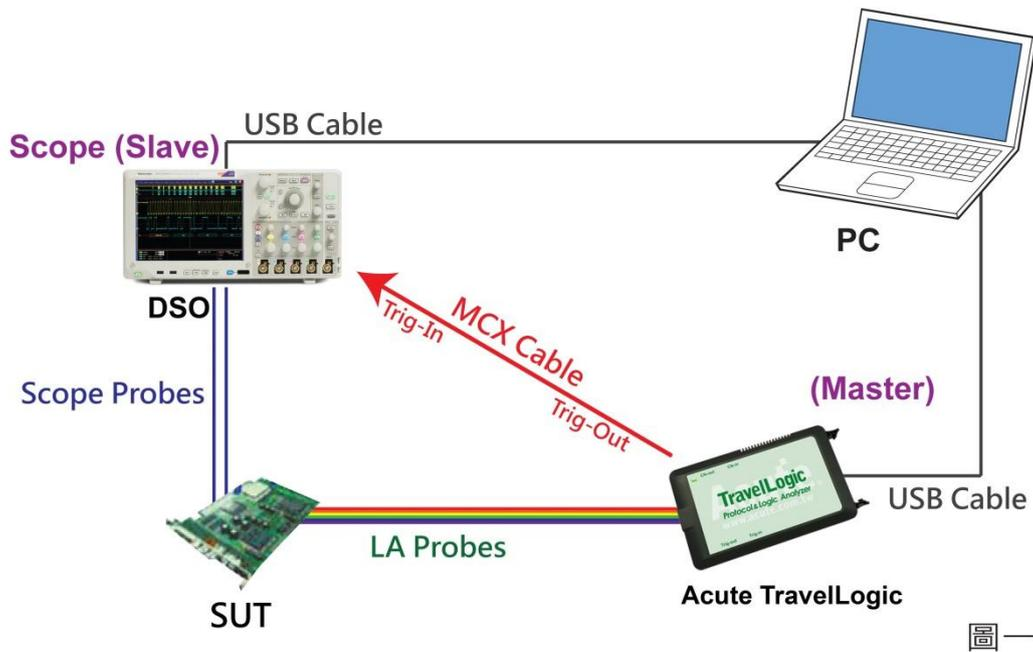
圖一中使用 USB 或 Ethernet(TCP/IP)的介面與電腦做連結，然後將 BNC-MCX cable 連接 TravelLogic Trig-Out 與示波器的觸發輸入接口(Ext-Trig、Aux In 或 Trig-In)。MDO4000 系列固定在類比通道 CH4。
