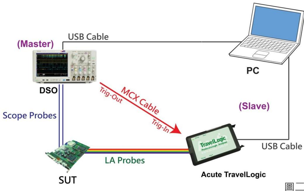
圖二中將 BNC-MCX cable 連接 TravelLogic Trig-In 與示波器的觸發輸出接口 (Trig-Out)。完成上述動作之後，按下「堆疊示波器」鈕。如下圖：
