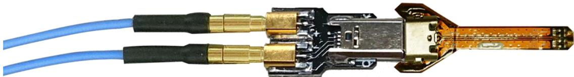
步骤二：再进行跳线焊接，这样可避免焊接好之后插上 SMPM Cable 时影响跳线。
