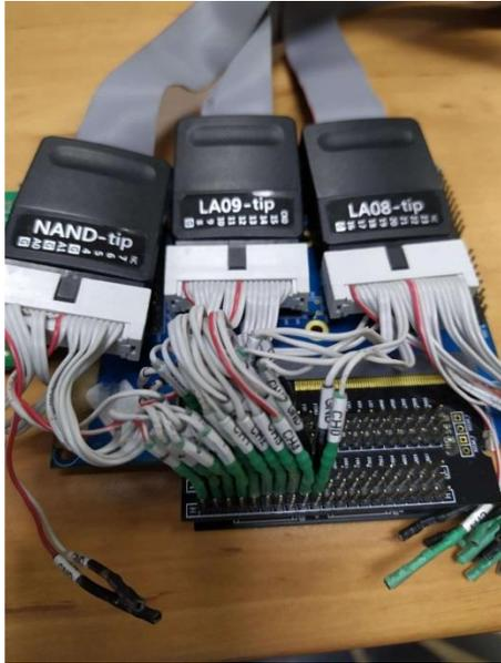
直接使用 tip 连接, 此种连接方式可以取得最佳的信号质量, 此图仅是示意图非真正连接 NAND Flash 待测物。
