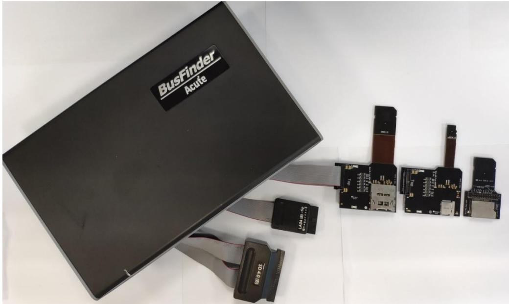
2. 搭配 SD 4.0 探棒組，可以量測 SD 4.0 訊號
