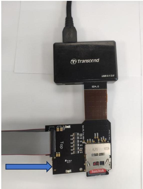
SD 4.0 比 SD 3.0 多了一條高速訊號線，使用時須將訊號線接上
