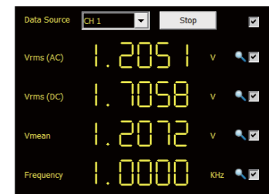
DVM 测量视窗监控 1KHz · 2.5Vpp 的方波
